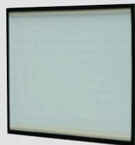
空気清浄装置には、手術室や無菌充填装置等で使用実績のある日本ケンブリッジフィルター社製産業用HEPAを採用。捕集効率0.3 $\mu$ m99.99%以上の全数検査を実施。この性能は0.1 $\mu$ m以上の微粒子に対して99.5%以上の捕集効率を有す。
