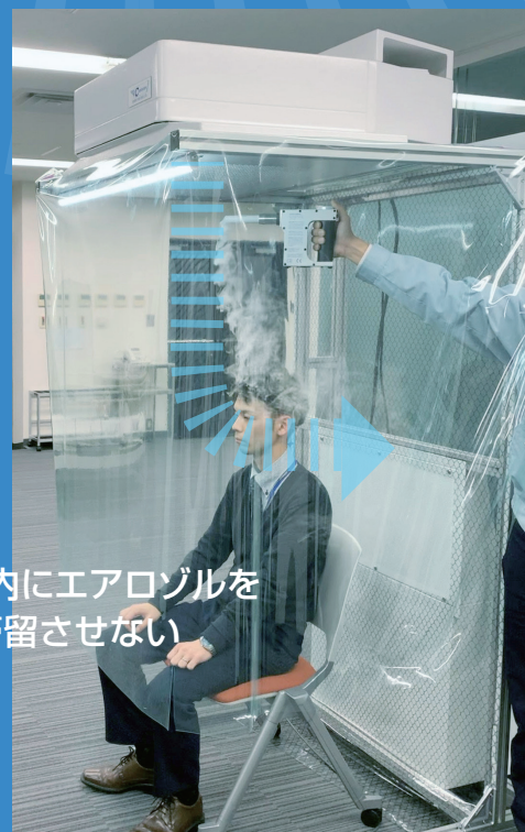
気流可視化確認試験
