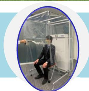
陰圧と気流コントロール、そして高捕集効率による3大ガード
