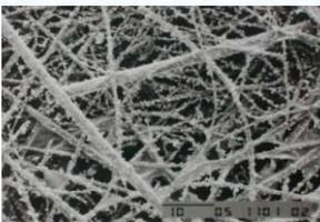
HEPAフィルタろ材に捕集されたサブミクロン粒子
